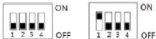
Figura 5. DIP SWITCH (UPLFP48-100_4U e exemplo de endereço "1")
