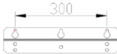
**Passo 3:** Gire a direção das placas de montagem 1 e 2 e instale-as novamente.
