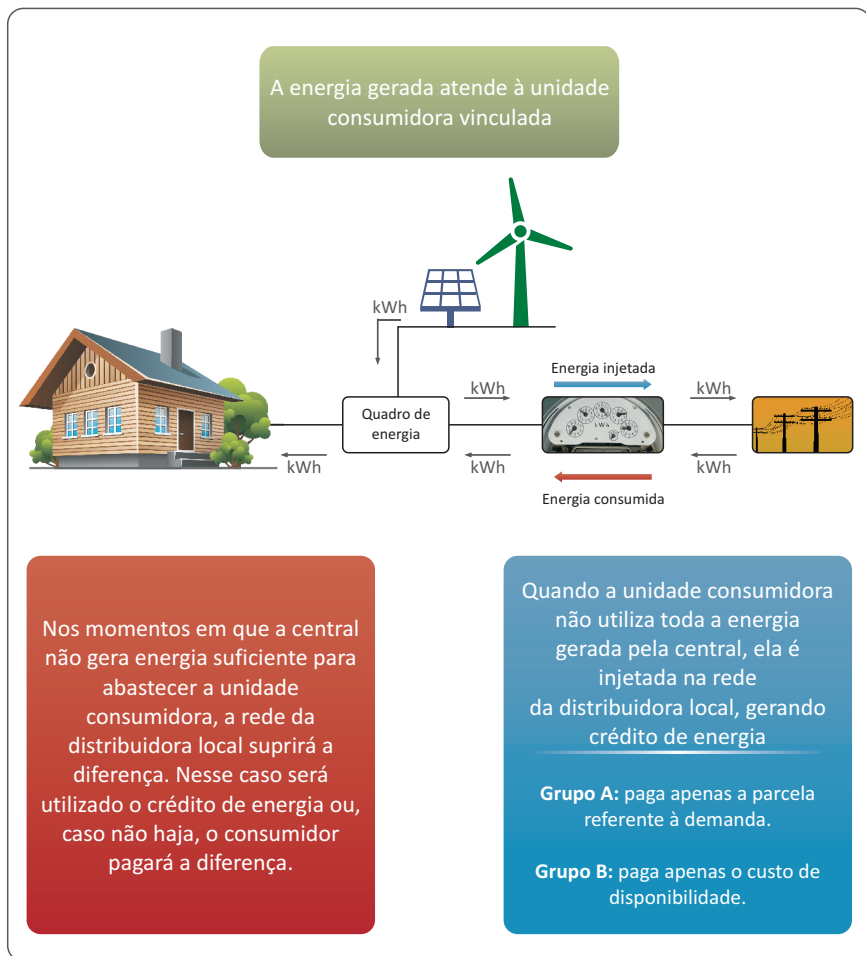
Figura 2 - Sistema de Compensação de Energia Elétrica
